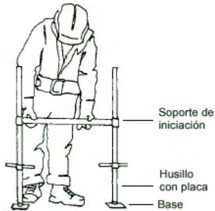
Figura 2. Introducción del soporte de iniciación en los husillos con placa
