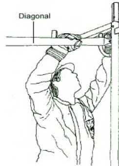
Figura 5. Colocación de la diagonal con abrazadera en el ensamble
