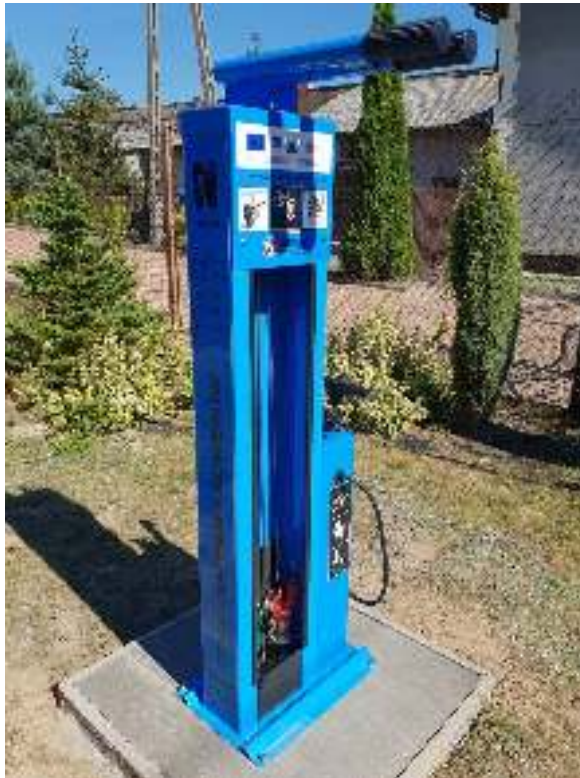
Poste de auto-reparación que incluye bomba de aire y las herramientas básicas.
