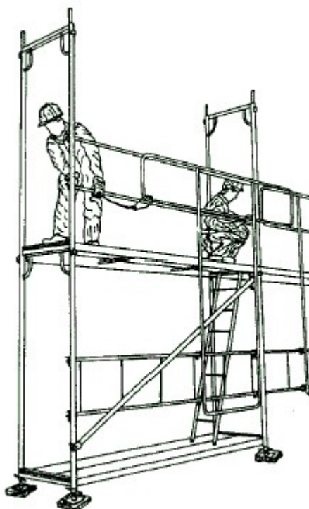
Figura 15. Montaje del resto del andamio
