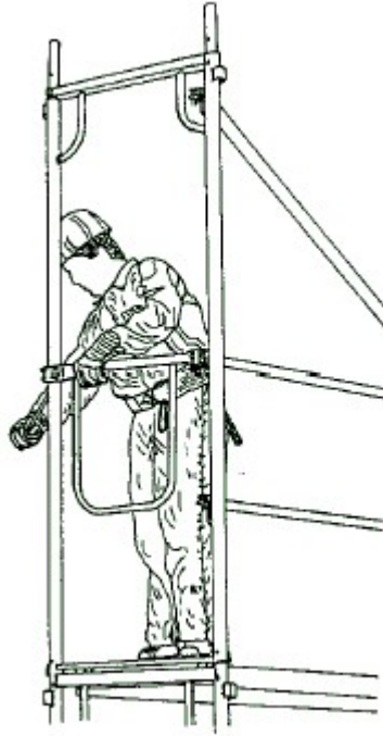
Figura 17. Colocación de barandillas esquinales.
