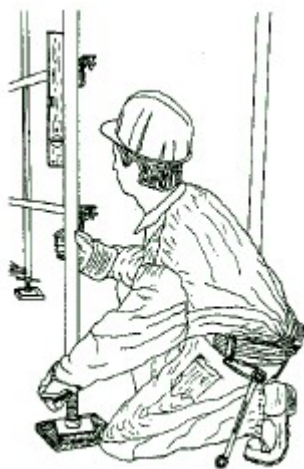
Figura 11. Comprobación de la nivelación vertical
