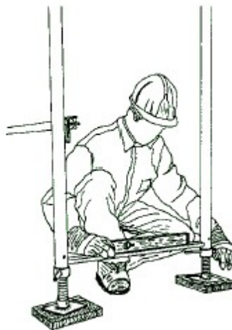
Figura 12. Comprobación de la nivelación horizontal
