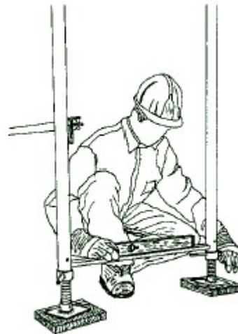
Figura 12. Comprobación de la nivelación horizontal
