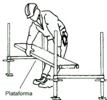
Figura 3. Colocación de la plataforma en los soportes de iniciación
