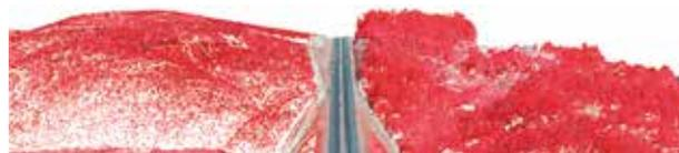
Figura 3. Representación del último rebote (suelo a la izquierda de la auto-vía), y del primero (copas) a la derecha, de una nube de puntos LiDAR.
