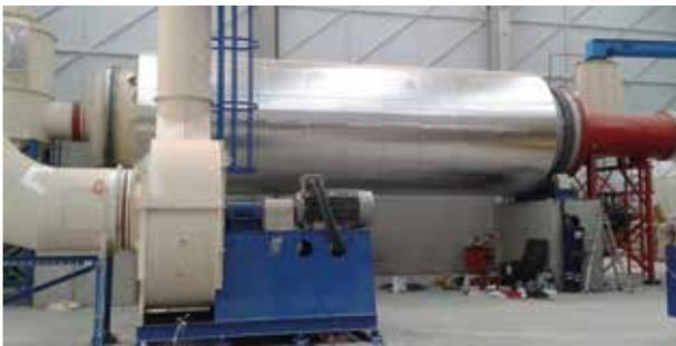
Imágenes 6 y 7. Línea de secado: horno de biomasa y trómel deshidratador.
