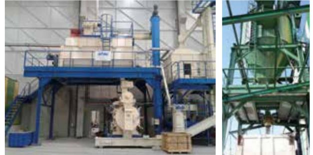
Imágenes 8 y 9. Línea de granulado y almacenado. Pelletizadora. Silo Externo.
