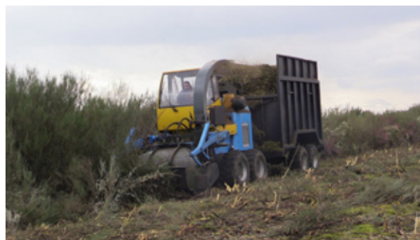
Figura 2. El triturador Retrabio trabajando en una mezcla de escoba, brezo y jara en Figueruela de Arriba (Zamora).
