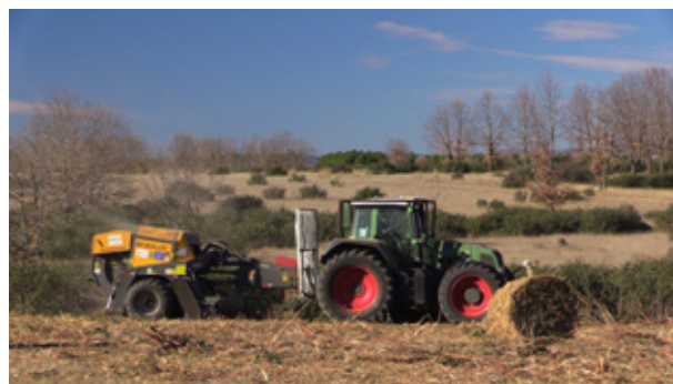
Figura 1. La empacadora Biobaler WB-55 trabajando en un pastizal invadido por estepas en Navalcaballo (Soria).
